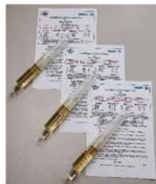
Rys. 9. Wzorce ciekłe firmy Morgan-Schaffer o różnych stężeniach gazów rozpuszczonych w oleju transformatorowym poświadczonych certyfikatem
