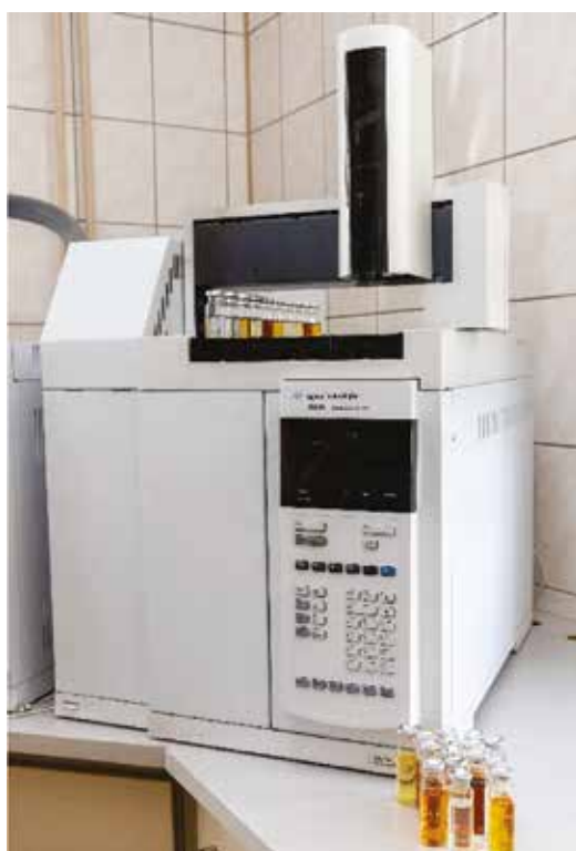
Rys. 7. Automatyczny dozownik próbek oleju (autosampler)
