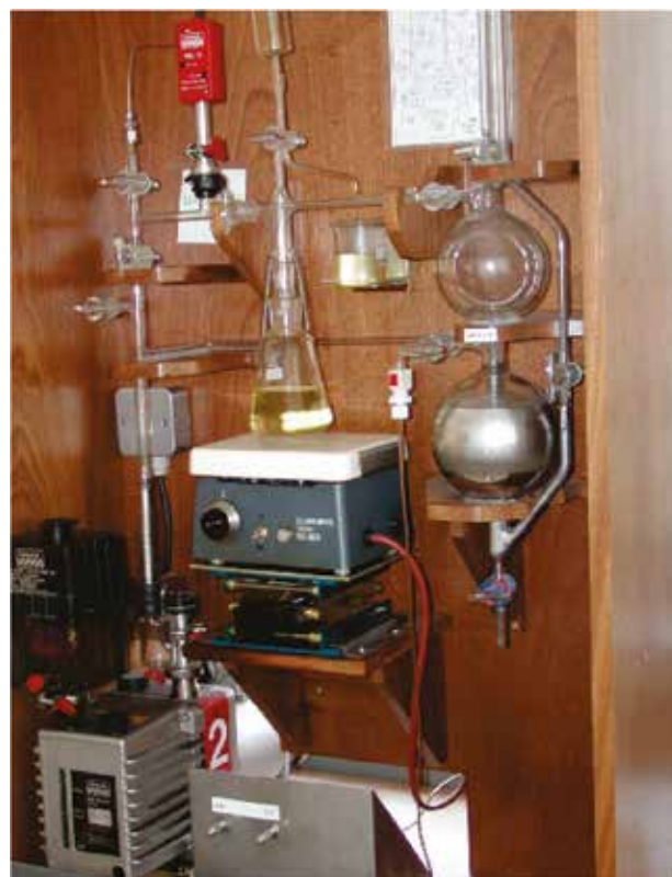
Rys. 4. Przystawka do próżniowego odgazowania oleju z udziałem rtęci
