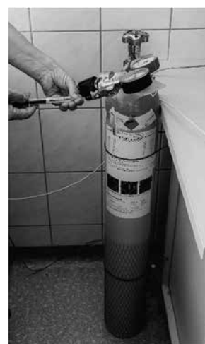
Rys. 3. Gaz do wzorcowania chromatografu zawierający mieszankę oznaczanych gazowych składników o ściśle określonym składzie (fot. poglądowa)
